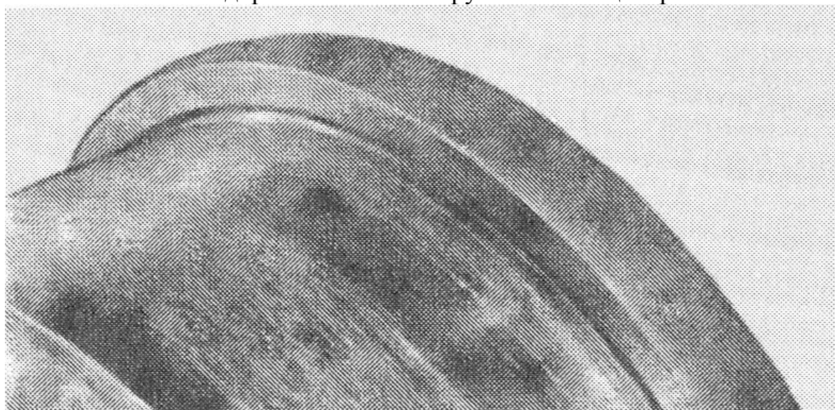
Рис. 33. Шелушение дорожки качения внутреннего кольца
